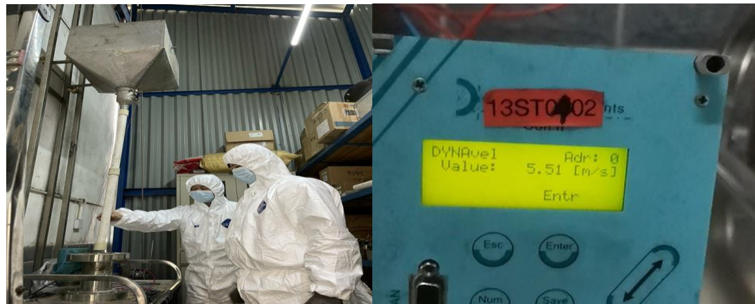
巴陵石化煤化工部利用备用速度计搭建速度计测试平台
